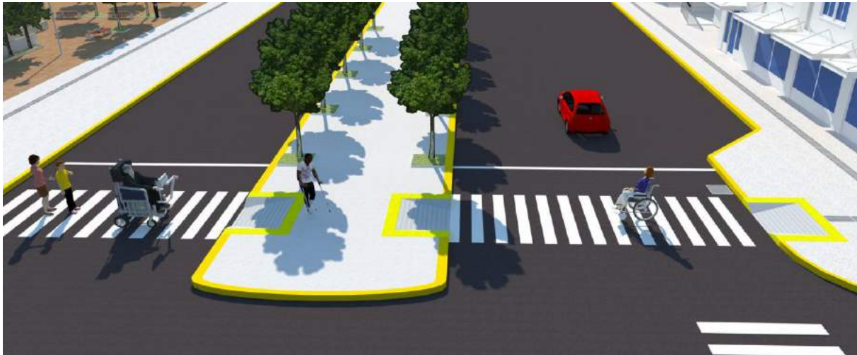
FIGURA 10. Vista de dos vías con parterre central en donde se salva mediante vados el desnivel existente entre el parterre y la calzada
