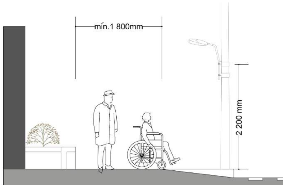
FIGURA 7. Detalle de corte transversal de un cruce peatonal por el que circulan una persona usuaria de silla de ruedas y otra persona a pie
